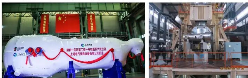
图 6-1 “国和一号”蒸汽发生器、屏蔽电机主泵
