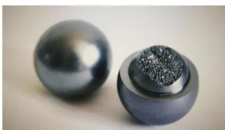
图 6-4 高温气冷堆 TRISO 包覆颗粒球形燃料
